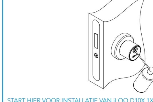
Reinig na 10.000 keer gebruik de contactrollen met plusvrije katoen. Spuit de contactrollen in met een kleine hoeveelheid hoge kwaliteit deurslotspray b.v. CRC lock oil met PTFE.
