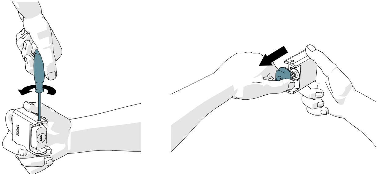
2. Avant d'installer le nouveau bouton, ajoutez une petite quantité de graisse au silicone CRC sur le joint IP du bouton.
