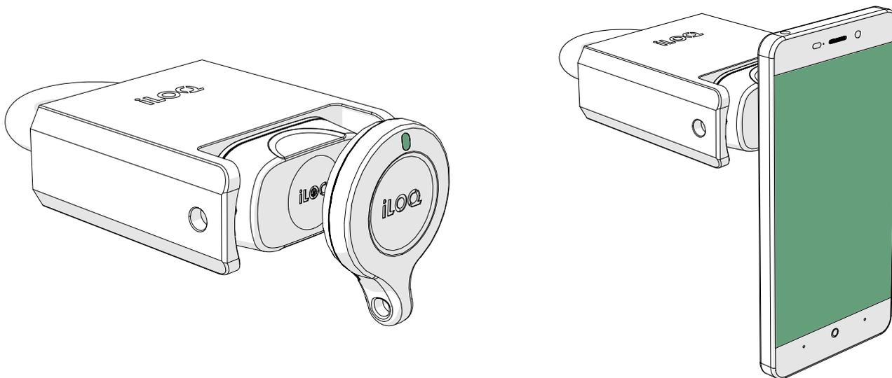
2. Tournez le bouton du lecteur à 180° dans le sens des aiguilles d'une montre. La serrure reste en statut ouvert pendant 5 à 15 secondes puis se remet automatiquement en statut fermé si elle n'est pas ouverte (selon la durée d'ouverture qui a été configurée).
