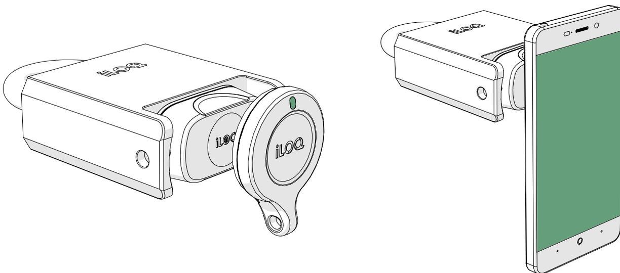
3. Tournez le bouton du lecteur à 180° dans le sens inverse des aiguilles d'une montre. La serrure reste en statut ouvert pendant 5 à 15 secondes puis se remet automatiquement en statut fermé si elle n'est pas ouverte (selon la durée d'ouverture qui a été configurée).
